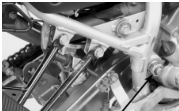
PARAFUSO/PORCA DA ARTICULAÇÃO DO BRAÇO OSCILANTE
