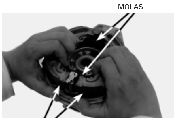
SAPATAS DO FREIO BRAÇO DO FREIO
