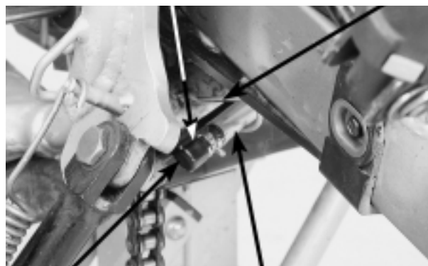
BUJÃO DA MANGUEIRA DE DRENAGEM DO RESPIRO
